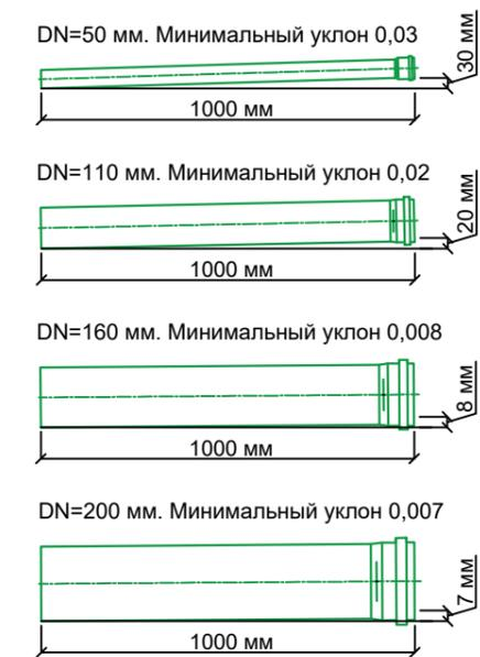
На втором этаже трубы канализации к сантехническим приборам вести по стене с уклоном не менее 0,002 для трубы Ø 110 и с уклоном не менее 0,003 для трубы Ø 50 на уровне отметки пола.
