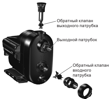
Рис. 20 Обратные клапаны входного и выходного патрубков
